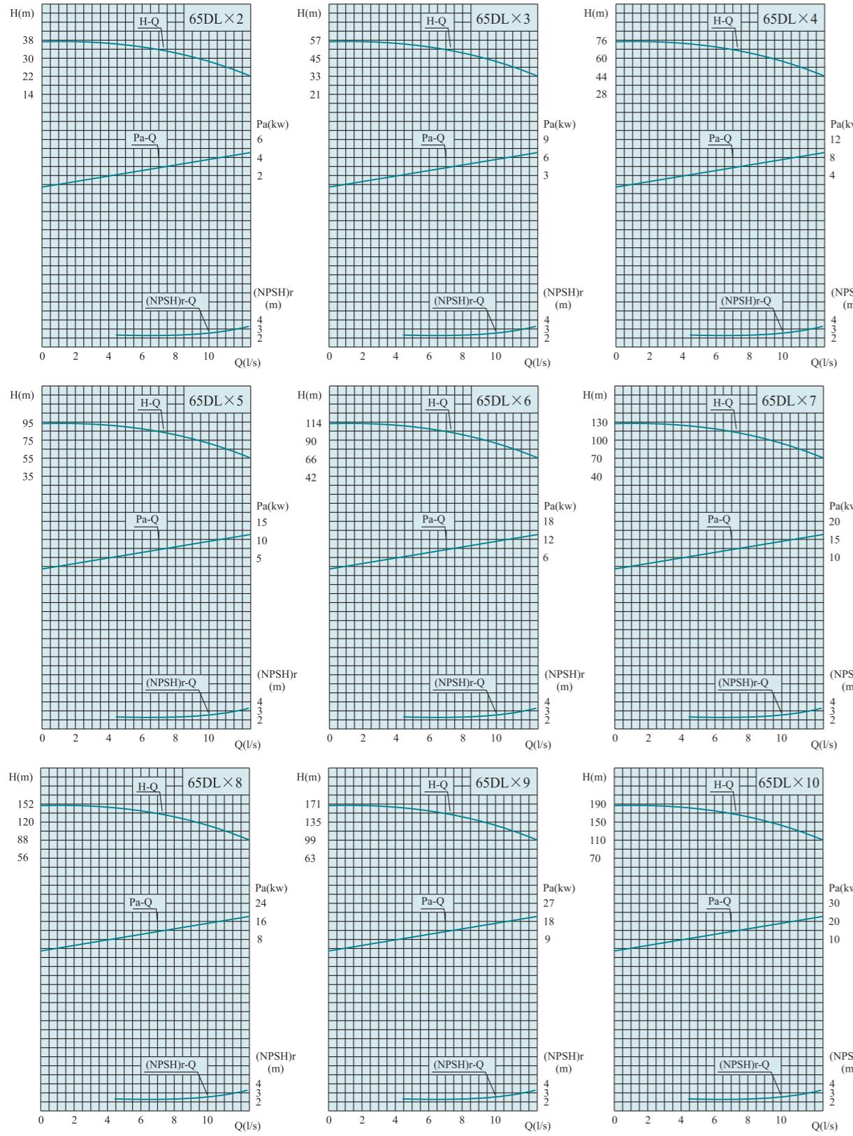
**DL SERIES VERTICAL MULTI-STAGE CENTRIFUGAL PUMP**
