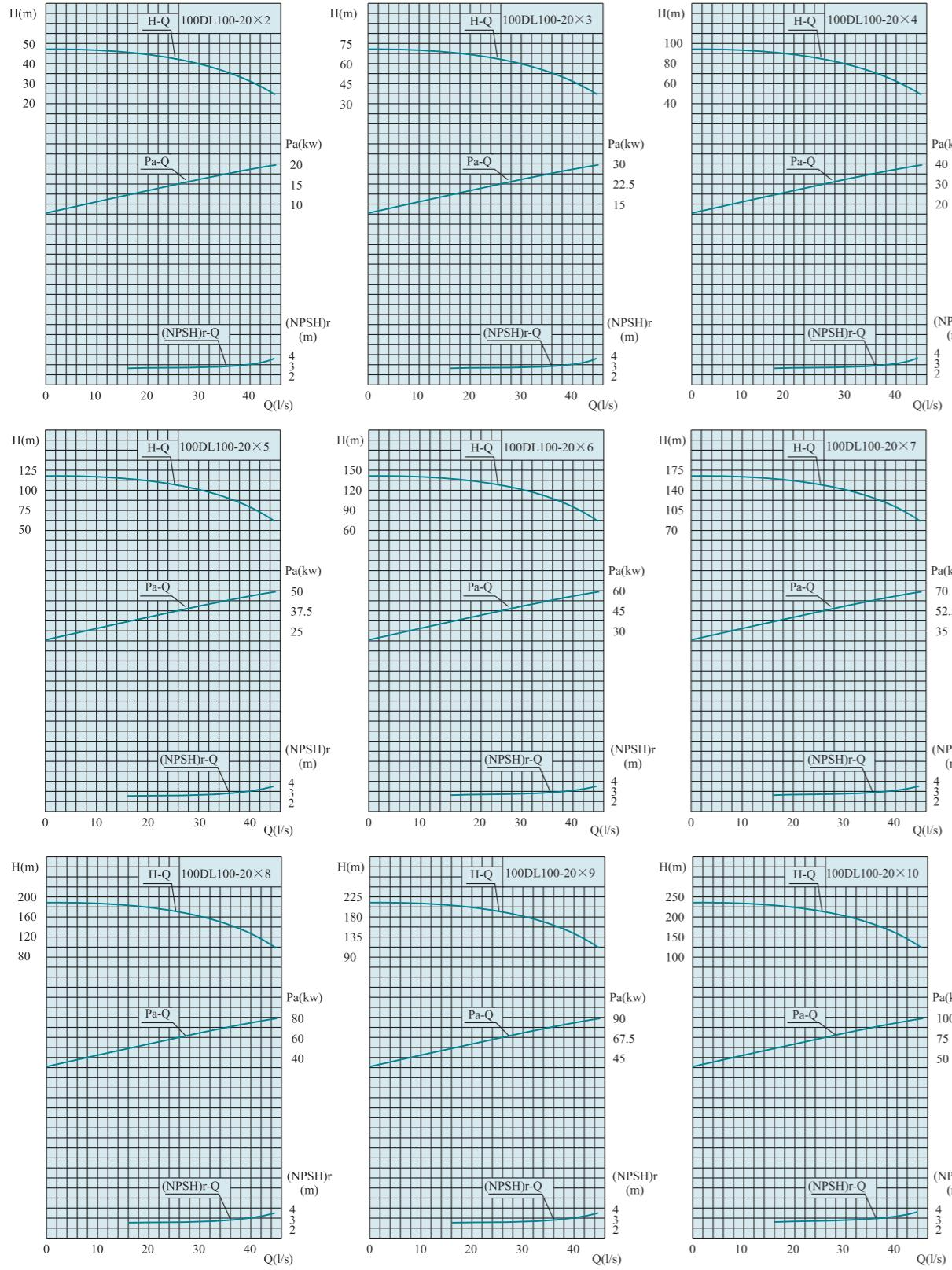
**DL SERIES VERTICAL MULTI-STAGE CENTRIFUGAL PUMP**
