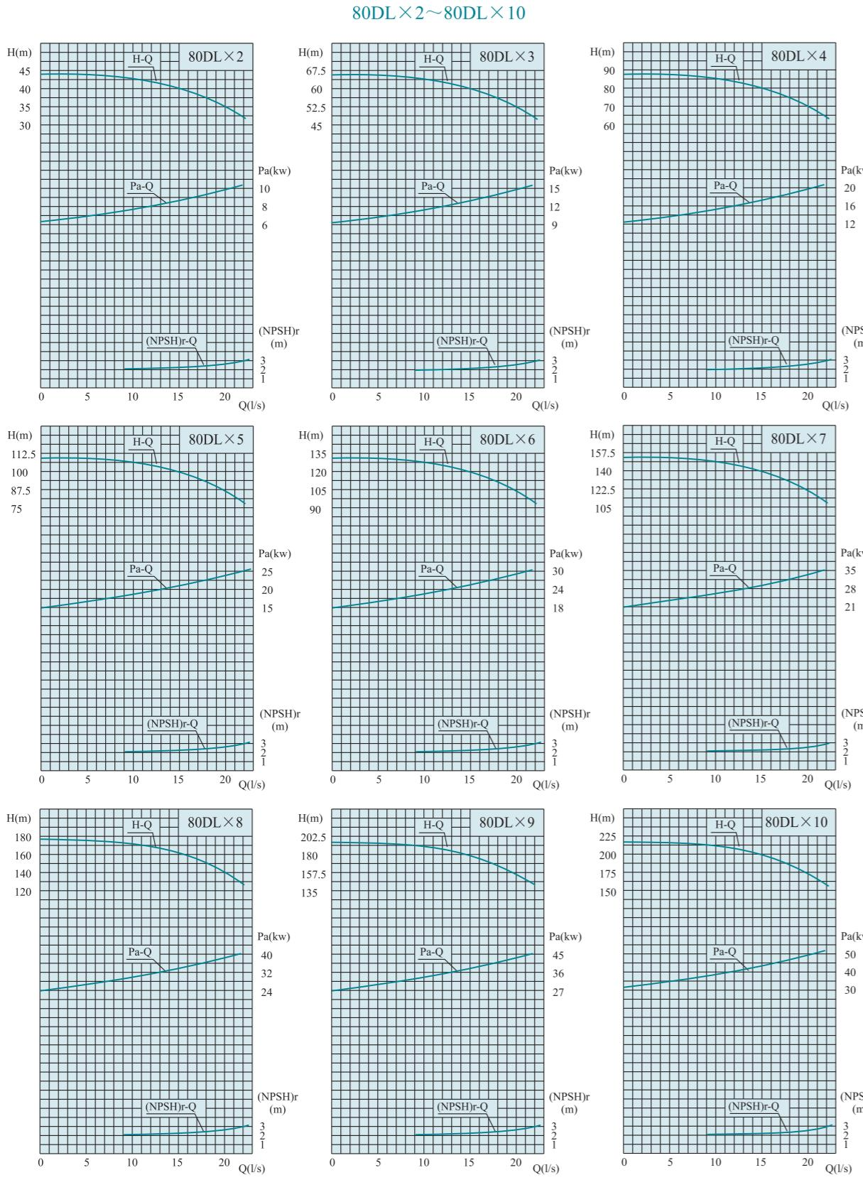
DL SERIES VERTICAL MULTI-STAGE CENTRIFUGAL PUMP
