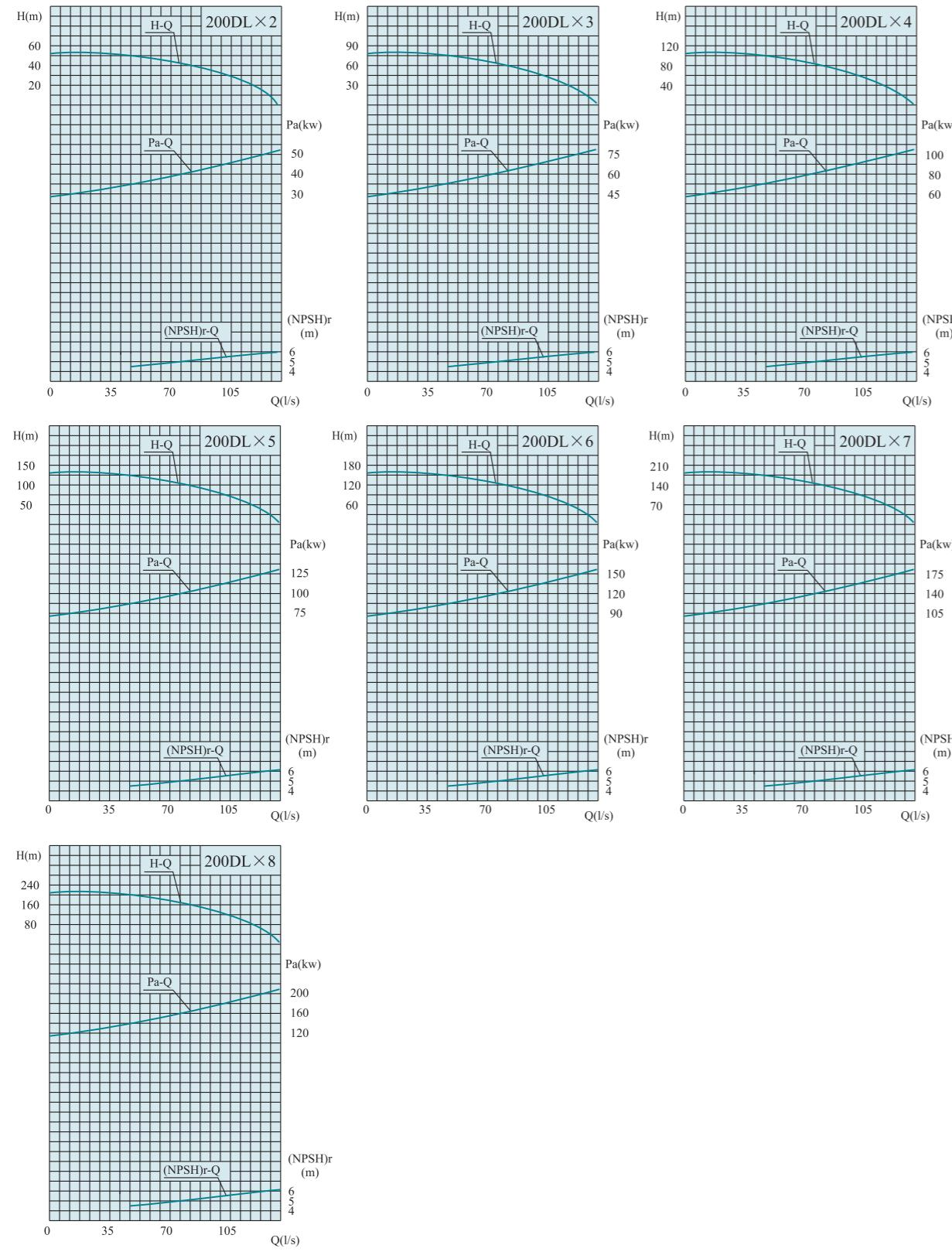
**DL SERIES VERTICAL MULTI-STAGE CENTRIFUGAL PUMP**
