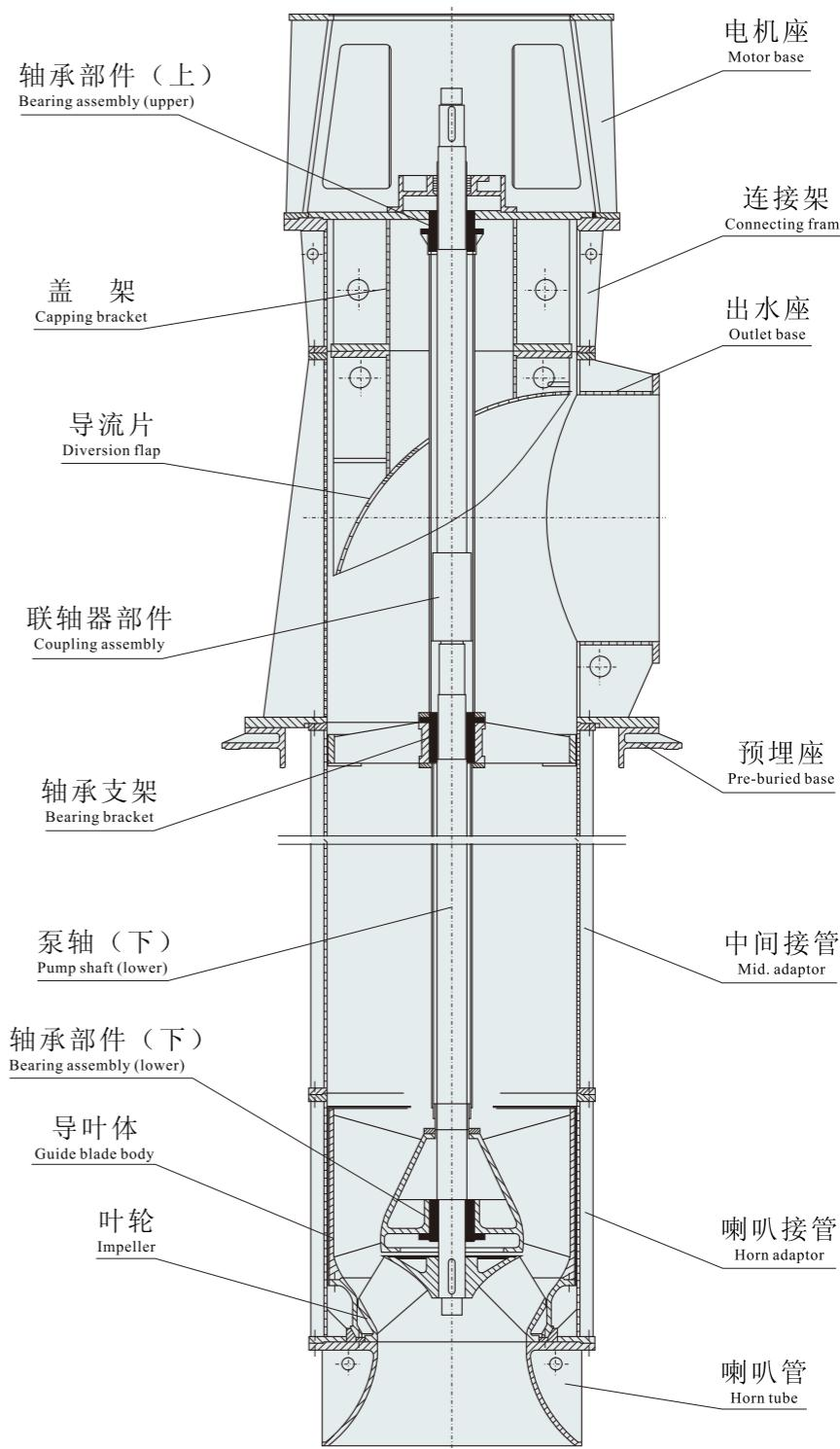
**LPTC型泵结构图(抽芯式结构)**
