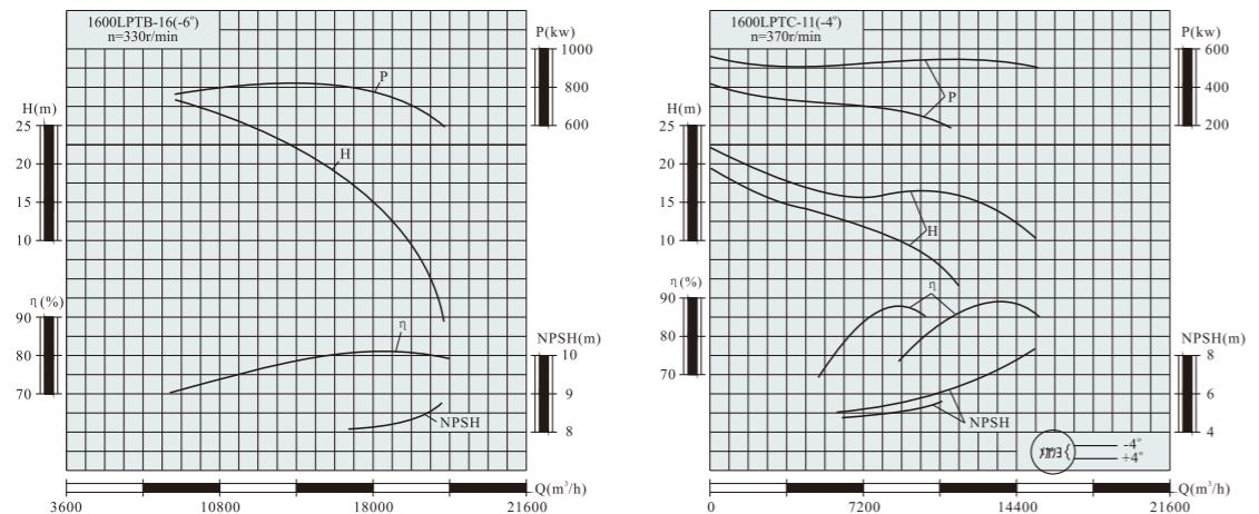
**LP(T) TYPE VERTICAL DISCHARGE PUMP**
