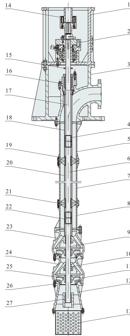
LP(T)型泵结构图(泵吐出口在基础之上)
