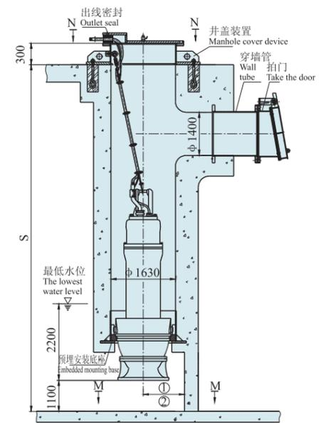
3、弯管悬吊式安装
