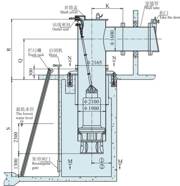
2、混凝土预制井筒式安装
