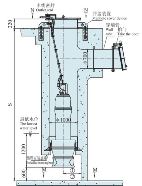
3、弯管悬吊式安装
