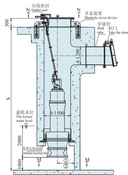
3、弯管悬吊式安装
