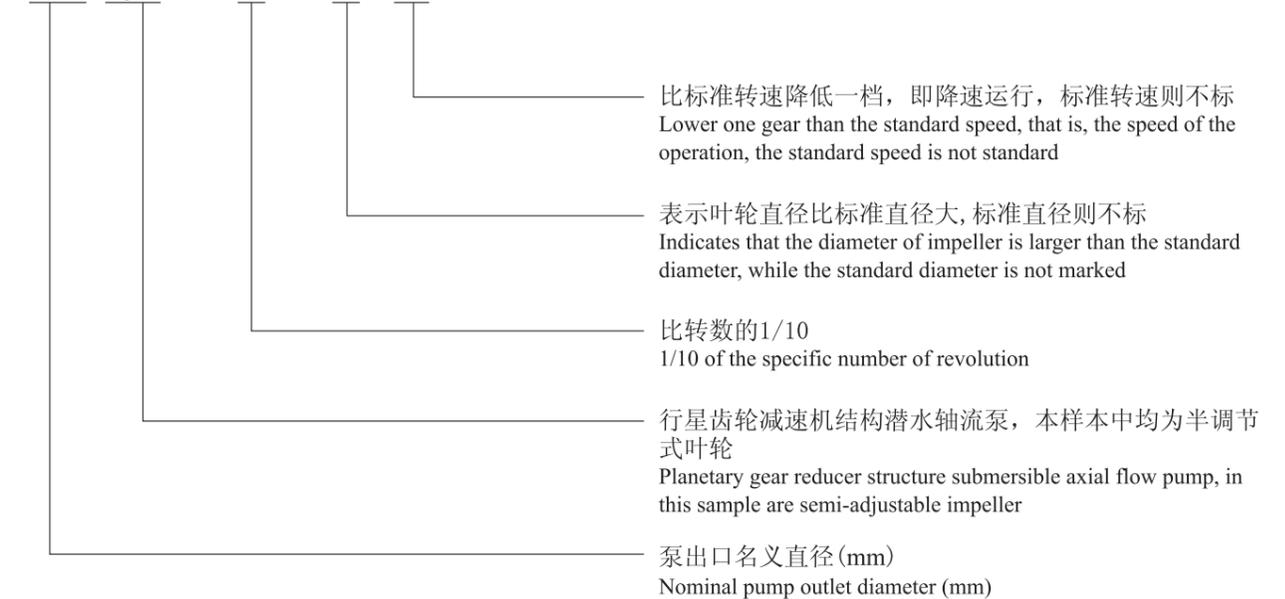
型谱图 Spectrum diagram
