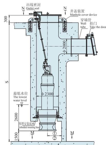
3、弯管悬吊式安装
