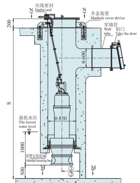
3、弯管悬吊式安装
