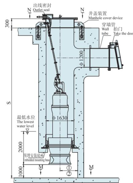
3、弯管悬吊式安装
