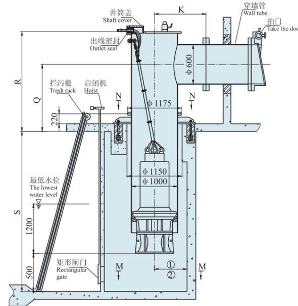
2、混凝土预制井筒式安装
