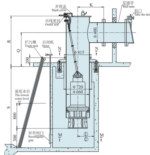
2、混凝土预制井筒式安装
