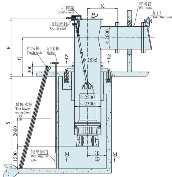
2、混凝土预制井筒式安装
