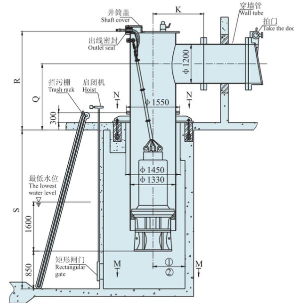
2、混凝土预制井筒式安装
