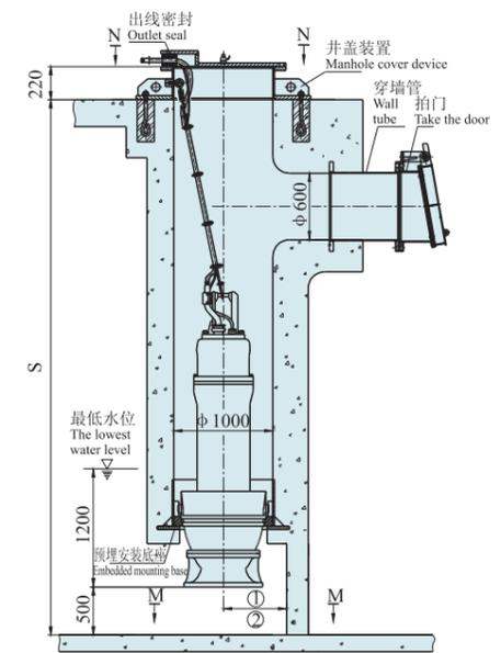
3、弯管悬吊式安装
