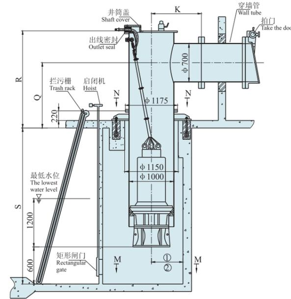
2、混凝土预制井筒式安装
