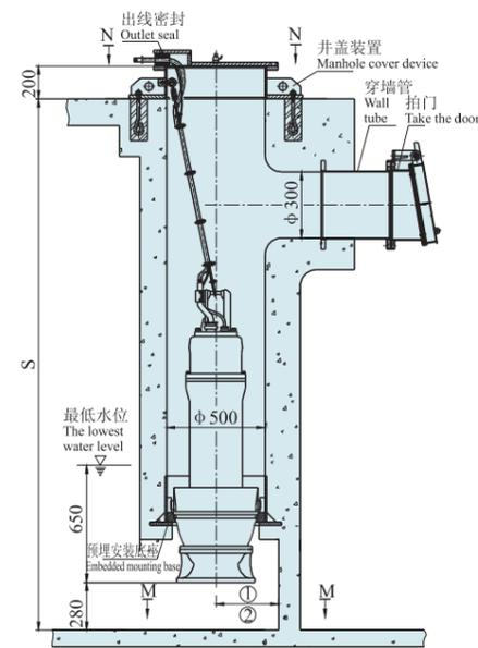
3、弯管悬吊式安装
