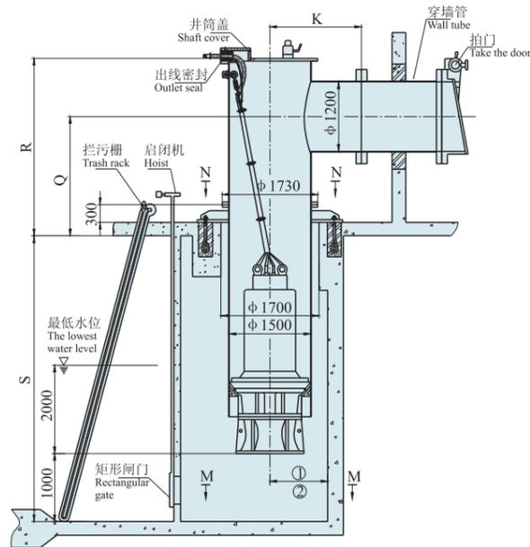
2、混凝土预制井筒式安装
