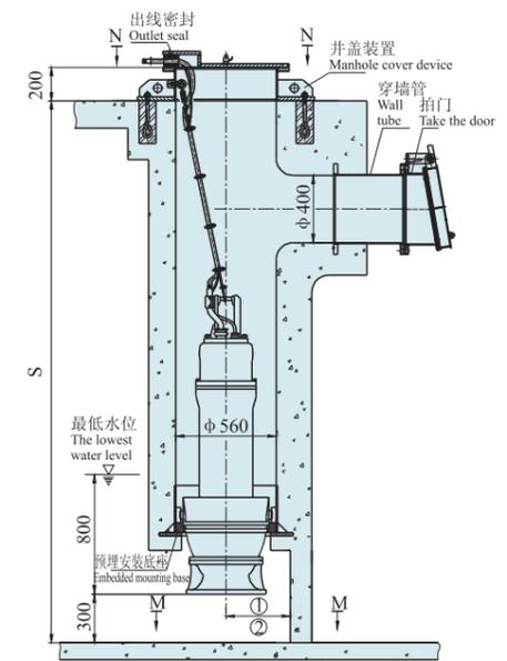
3、弯管悬吊式安装
