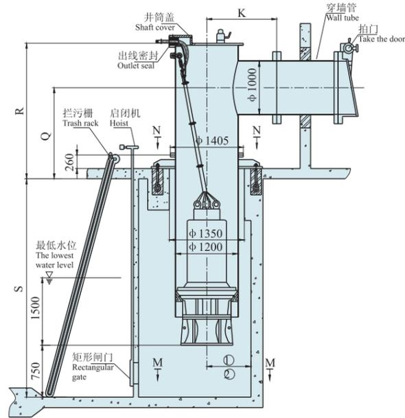
2、混凝土预制井筒式安装
