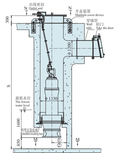
3、弯管悬吊式安装
