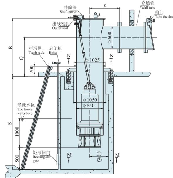
2、混凝土预制井筒式安装
