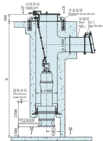
3、弯管悬吊式安装
