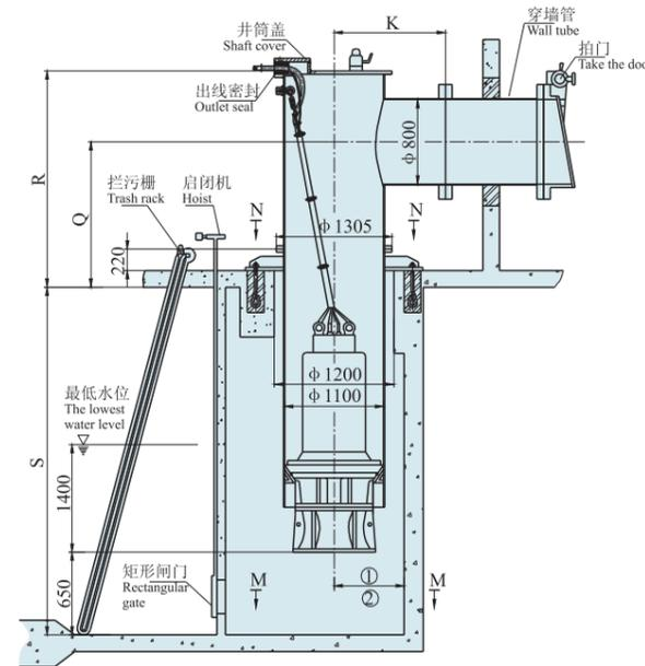
2、混凝土预制井筒式安装
