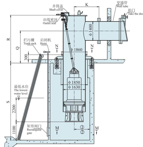
2、混凝土预制井筒式安装
