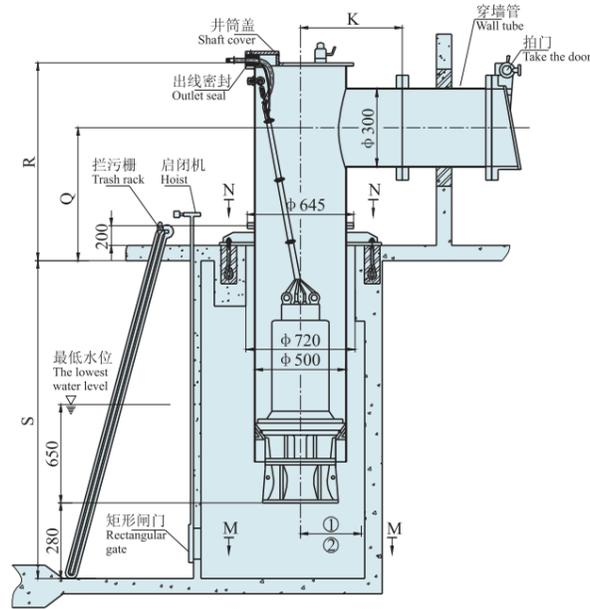
2、混凝土预制井筒式安装
