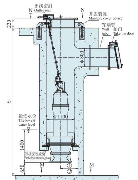
3、弯管悬吊式安装
