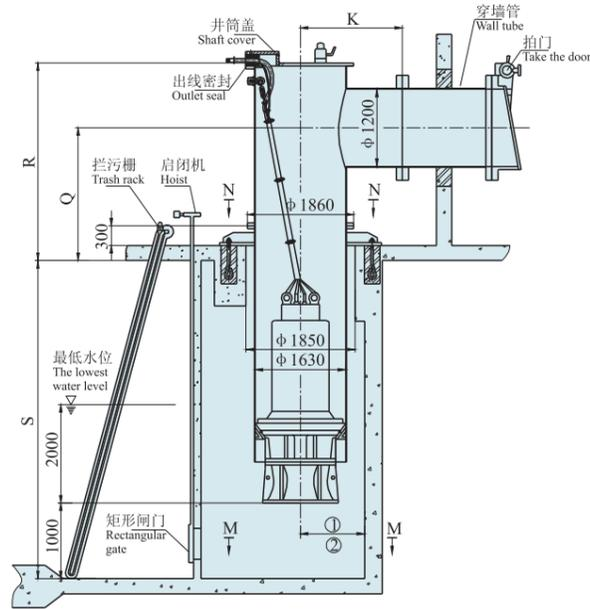
2、混凝土预制井筒式安装
