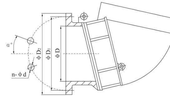
B.配重式拍门外形图及联接尺寸表
