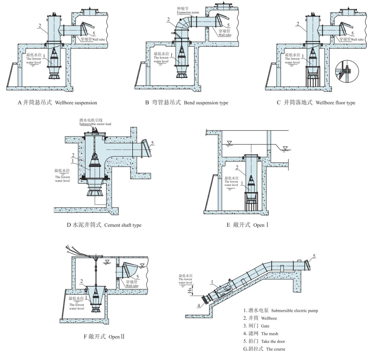
说明：图中前四种安装型式列有安装外形尺寸图和表，推荐A, B, C使用图所示的安装形式，其余安装型式的外形尺寸在咨询时提供。
